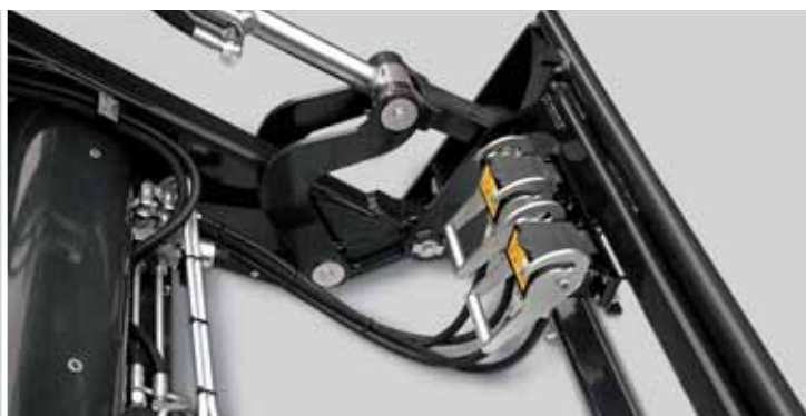
Także dla hydraulicznie uruchamianych narzędzi roboczych dostępny jest HYDRO-FIX na ramie szybkiej wymiany.
