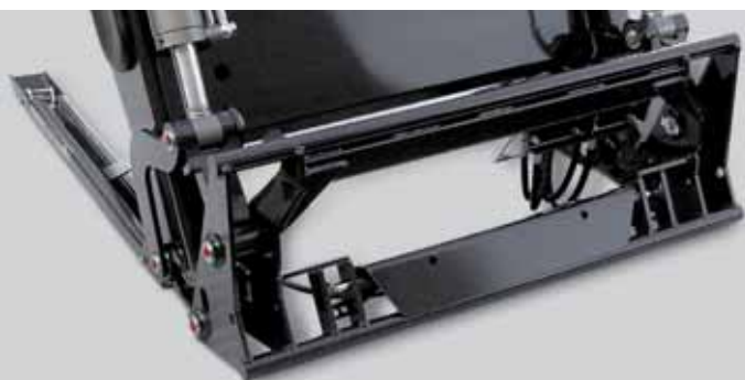
Hydrauliczne rygłowanie narzędzi HYDRO-LOCK jest dostępne na życzenie.
