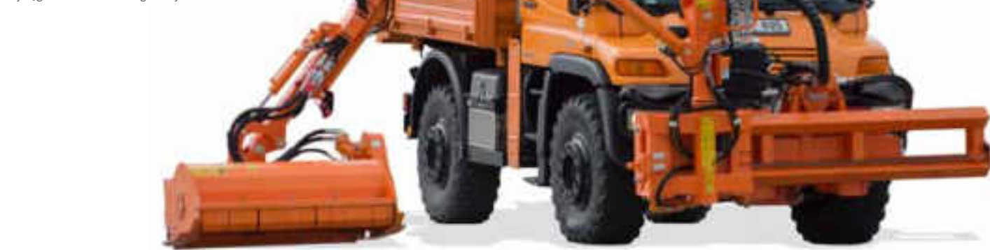
Wykaszanie trudnodostępnego pobocza za pomocą wysięgnika WWP500UH i głowicy GK 110.
