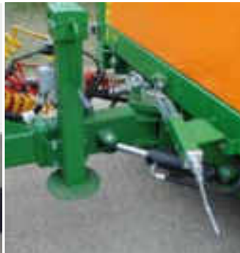
Hydrauliczny skręt dyszla
