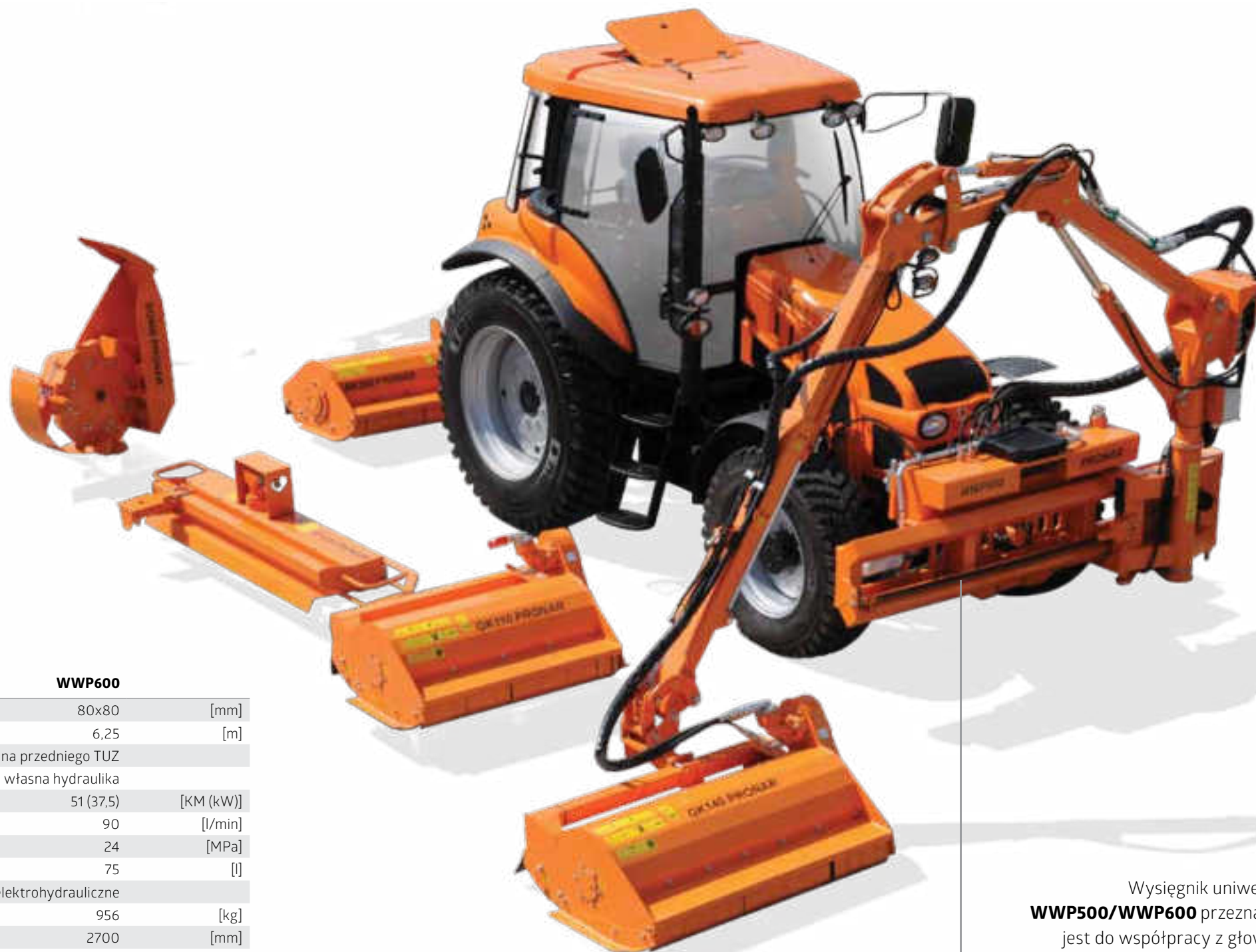
Wysięgnik WWP600 - przesuw hydrauliczny ramienia roboczego po prowadnicy
