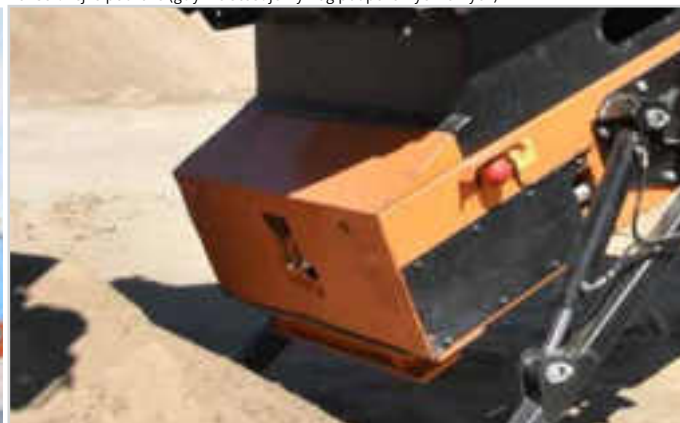
Podpora w tylnej części przenośnika chroni osłony przed uszkodzeniem przy opieraniu konstrukcji o podłogę (gdy nie stosujemy nóg podporowych)
