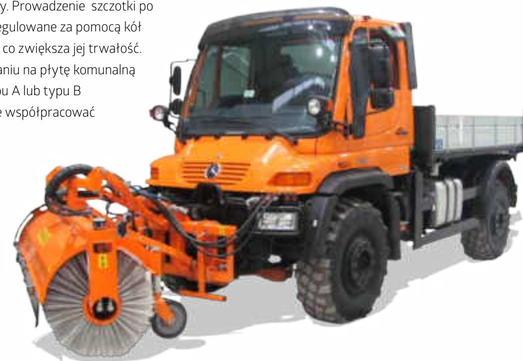
Hydrauliczny skręt szczotki ± 30°
