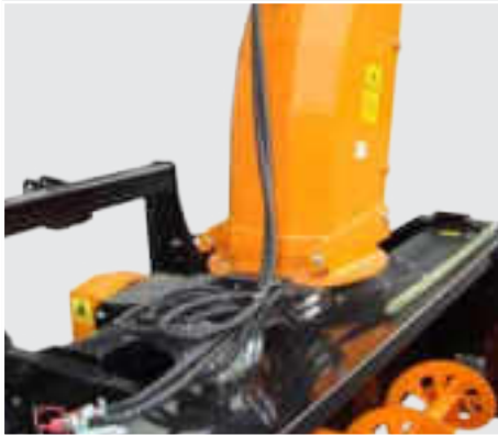
Hydrauliczny obrót komina i regulacja odległości wyrzutu
