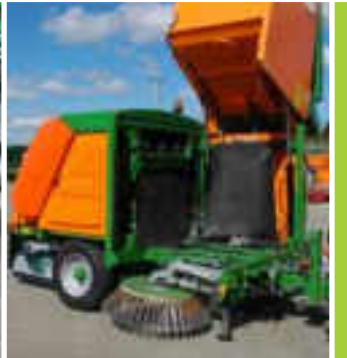
Hydrauliczne opróżnianie kosza
