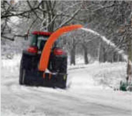
Komin wysokiego wyrzutu
