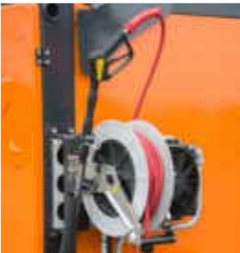
Myjka ciśnieniowa -ciśnienie wody do 150 bar
