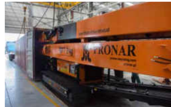
Kompaktowa konstrukcja umożliwia transport w kontenerze 40HQ
