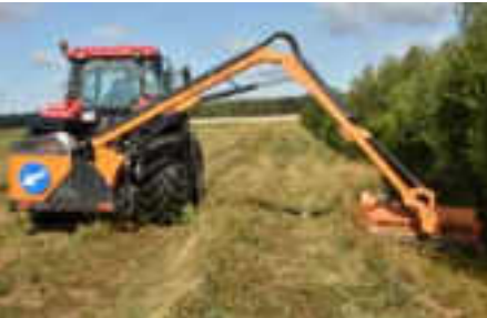
Wysięgniki WWT600 służą do pracy z ciężkimi głowicami w trudnodostępnych miejscach
