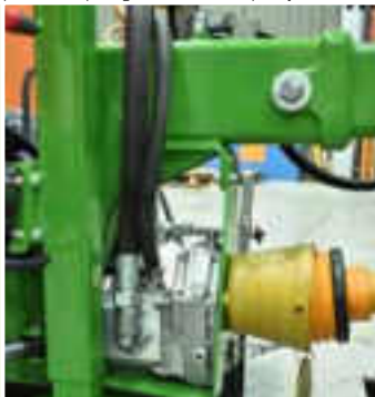
Multiplikator napędzany z WOM ciągnika przez wał przegubowo-teleskopowy
