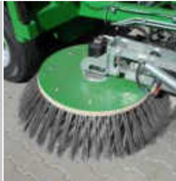
Hydrauliczna regulacja położenia szczotek talerzowych
