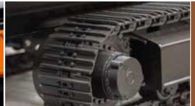
Napęd gąsienicowy pozwala na przemieszczanie po placu roboczym bez dodatkowych ciągników
