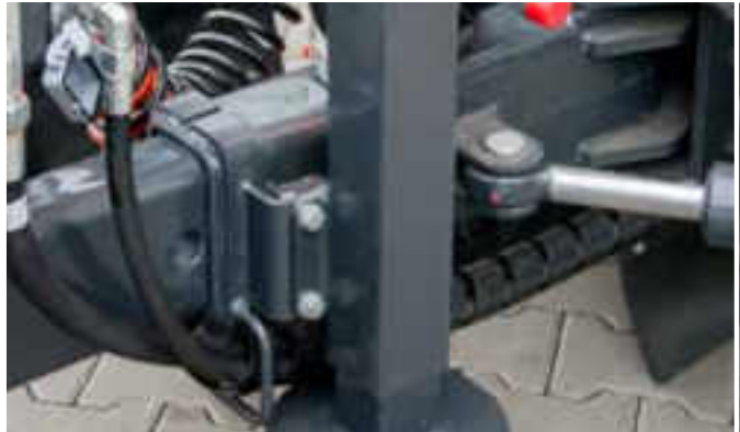
Dyszel -skrętny dyszel dolny - opcjonalnie dyszel górny
