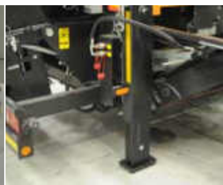
Hydrauliczne stopy podporowe zwiększają komfort pracy operatora oraz zapewniają większą stabilność przesiewacza podczas pracy
