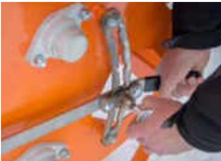
Ręczna regulacja gęstości sypania dociskiem przystony walca posypującego
