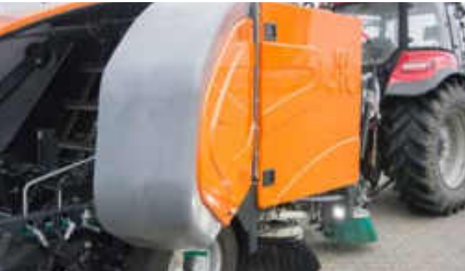
Układ zraszania -duża pojemność zbiornika pozwala jednorazowo zatankować 1120 l wody, co umożliwia długotrwałą pracę w komfortowych warunkach
