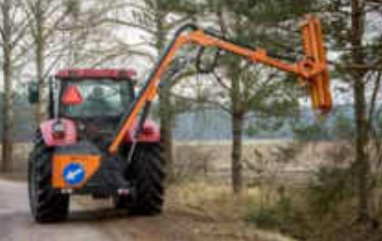
WWT700T, WWT800T – Duży zasięg realizowany jest dzięki ramieniu rozsuwającemu się za pomocą siłownika teleskopowego
