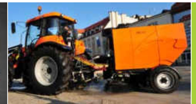
Hydraulicznie skrotny dyszel
