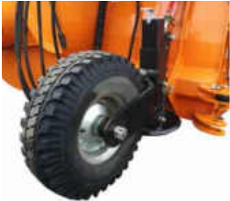
Ślizgi i kółka podporowe do utrzymania dystansu między powierzchnią, a lemieszami (do ograniczenia grubości odgarnianej warstwy)
