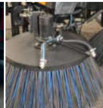
System zraszający przed szczotkami talerzowymi
