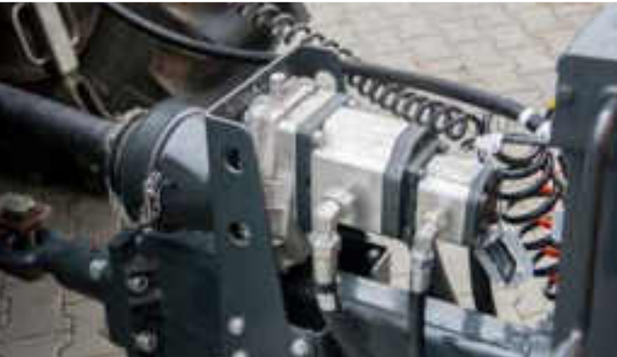
Hydraulika -hydraulika z dwiema pompami hydraulicznymi i chłodnica oleju
