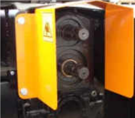
Przekładnia z dwoma końcówkami WOM (540/1000 obr/min)
