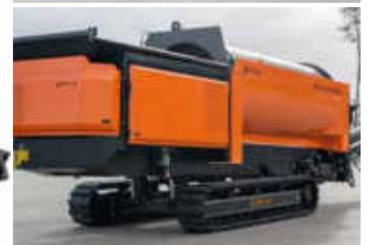
Układ hydraulicznego unoszenia ramy MPB 20.55gh pozwala wypoziomować maszynę do pracy na pochyłościach wzdłużnych i zwiększa prześwit ułatwiając pokonywanie nierównego terenu.
