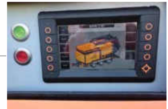
Dotykowy panel sterujący wszystkimi funkcjami maszyny
