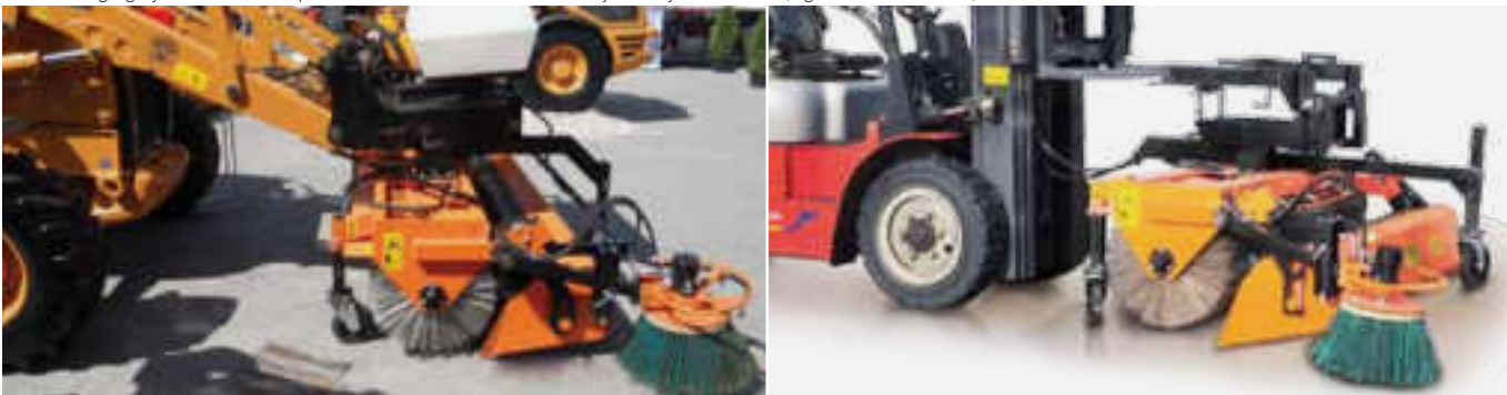
Możliwość agregacji zamiatarki na koparko-ładowarkach, wózkach widłowych i innych nośnikach (wg zamówienia klienta)
