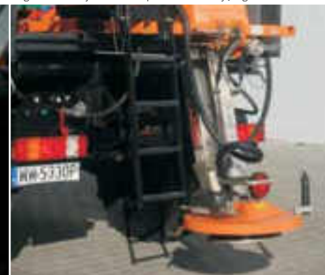
Regulowana wysokość adaptera rozsiewającego.
