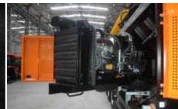
Silnik i układ hydrauliczny umieszczone są na obrotowej ramie co zapewnia łatwy dostęp przy czynnościach serwisowych
