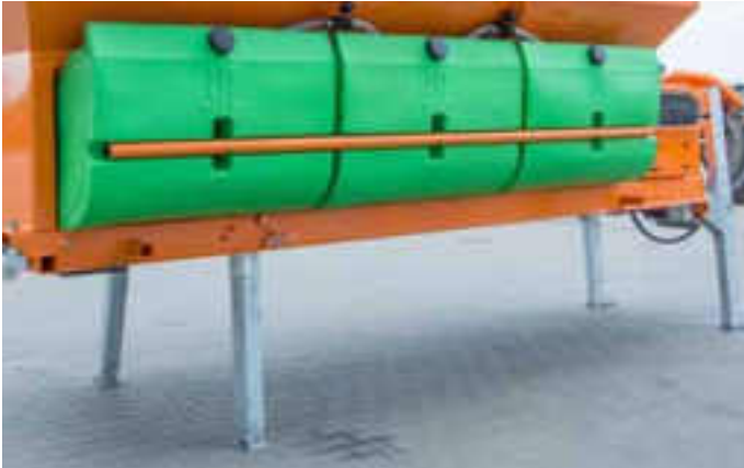
Nogi podporowe o regulowanej wysokości umożliwiające załadunek maszyny na wywrotkę bez użycia dodatkowych urządzeń (system RORO)
