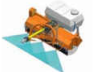
Napęd mechaniczny szczotki z WOM z układem zraszania
