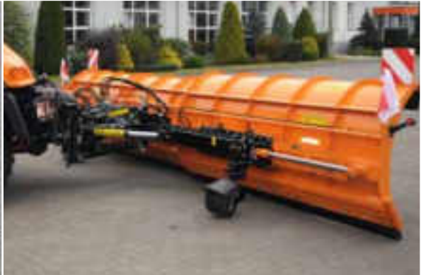
Sposób mocowania – Płyta komunalna DIN76060 typ A
