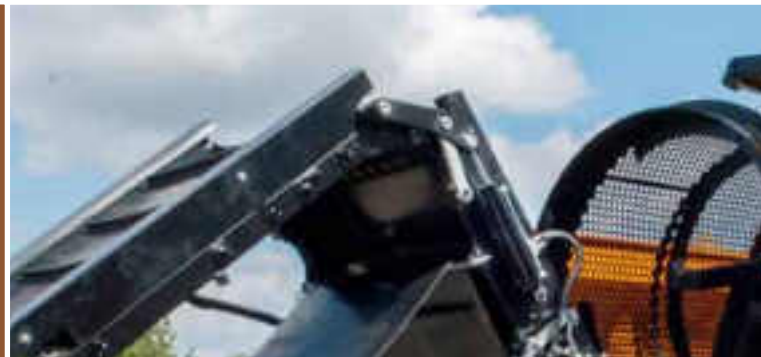
Tylny przenośnik składany jest za pomocą dwóch siłowników
