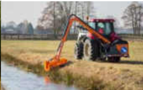
WWT620D - lekkaisztynakonstrukcja,wynikająca z zastosowania do jej budowy stali wysokowytrzymałej, kompaktowe rozmiary wysięgnika.
