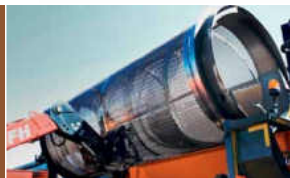
Szybka i łatwa wymiana bębna przesiewającego
