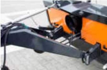
Zasilanie z WOM 540 pozwala agregować kosiarkę z ciągnikami o małej mocy od 50 KM
