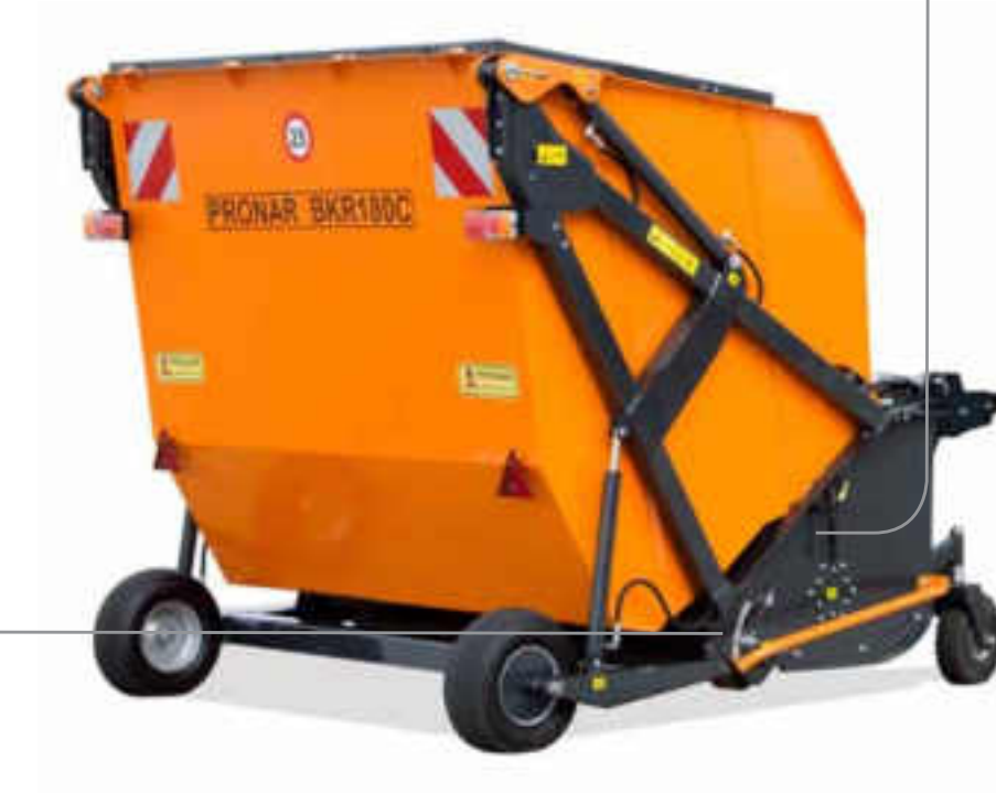
Zasilanie z WOM 540 pozwala agregować kosiarkę z ciągnikami o małej mocy od 50 KM
