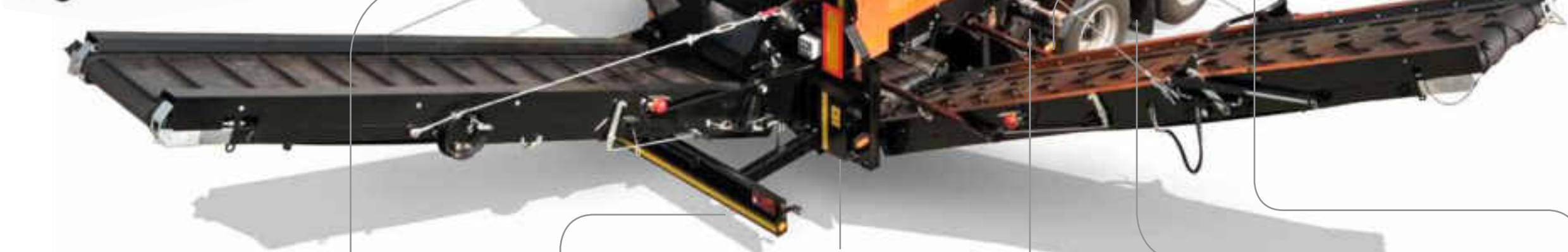
Hydrauliczne stopy podporowe zwiększają komfort pracy operatora oraz zapewniają większą stabilność przesiewacza podczas pracy
