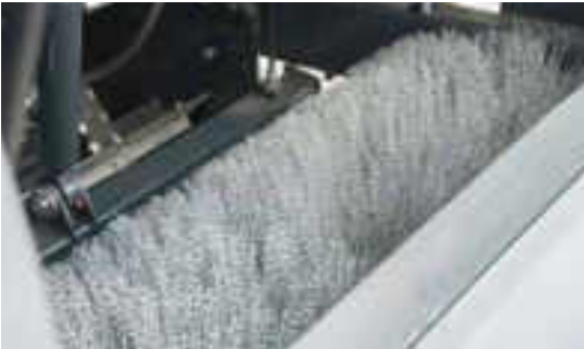
Szczotka walcowa -wykonana z wymiennych segmentów talerzowych
