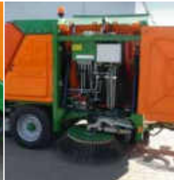
Uchylnie wrota serwisowe. Czujnik po otwarciu zatrzymuje maszynę
