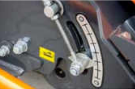
Bezstopniowa regulacja wysokości koszenia
