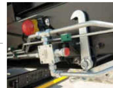
Regulacja prędkości przesuwu taśmy podajników – umożliwia dostosowanie prędkości do rodzaju przesiewanego materiału tak, aby maksymalnie wykorzystać oferowaną wydajność mobilnego przesiewacza bębnowego. Pozwala również na usypianie większej ilości materiału każdej z frakcji bez konieczności przemieszczania maszyny
