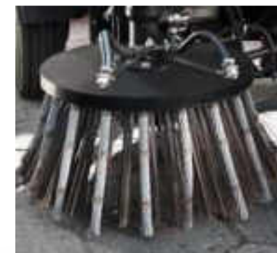
Specjalna szczotka do usuwania roślin przy krawędzi jezdni
