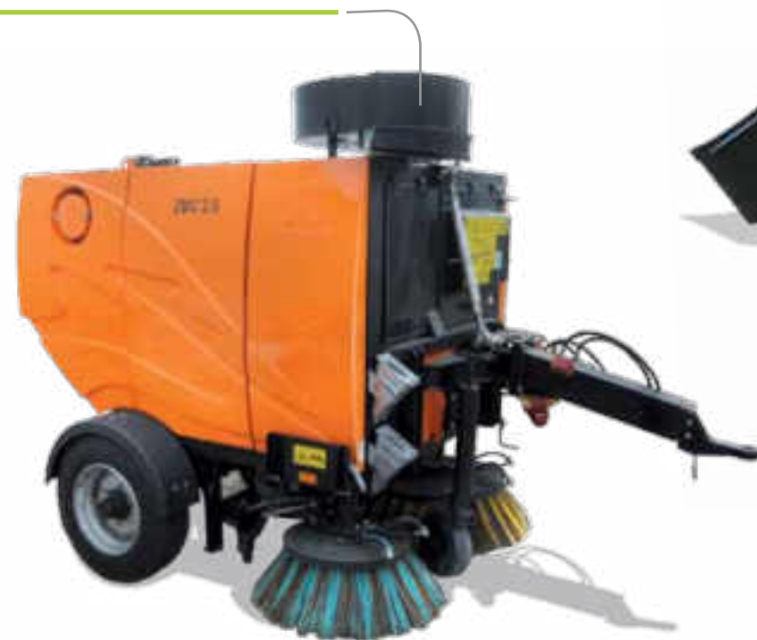
System zraszający przed szczotkami talerzowymi
