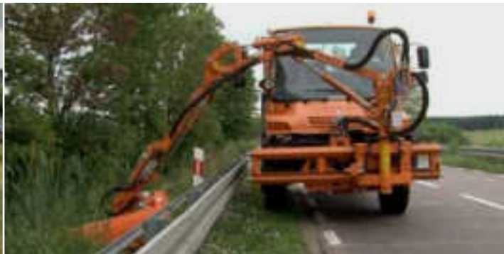
Wykaszanie trudnodostępnego pobocza za pomocą wysięgnika WWP500U i głowicy GK 110.
