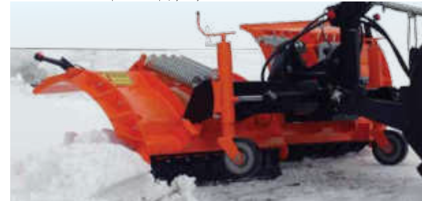
Łamana odkładnica z zabezpieczeniem sprężynowym
