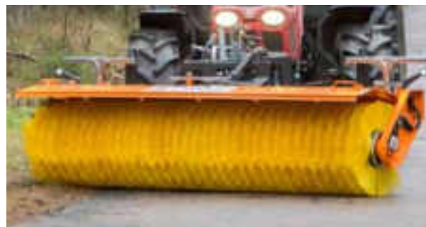
Dostępne 8 typów szczotki walcowej (4 twardości włosia szczotki i 2 typy pierścieni - płaskie lub „plaster miodu”)
