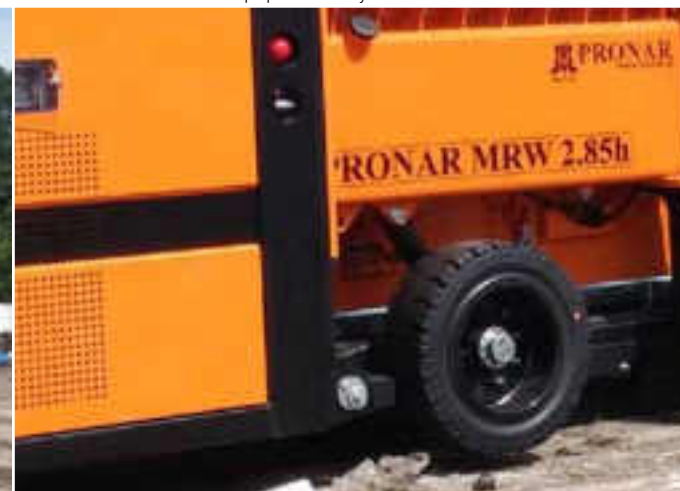
MRW 2.85h - koło do wleczenia po placu roboczym
