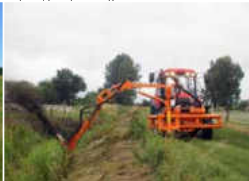
Wysięgnik WWP600 - ramię o zasięgu do 7 m pozwala na wykonanie zabiegów w trudno dostępnych miejscach: przydrożne rowy, skarpy, rowy melioracyjne
