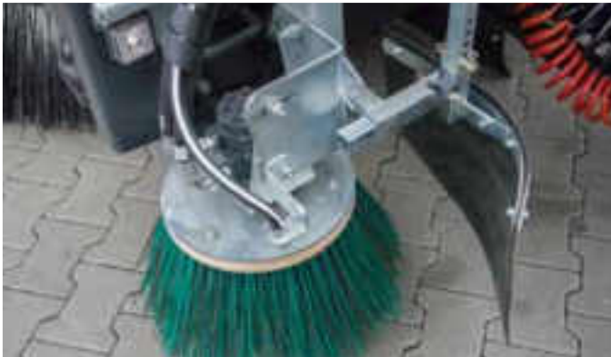
Szczotka boczna-prawa lub szczotka boczna lewa -zwiększenie szerokości zmiatania; zasięg: 700mm poza obrys maszyny
