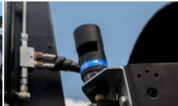
Wielofunkcyjny kogut sygnalizuje tryb pracy (przesiewanie/jazda)
