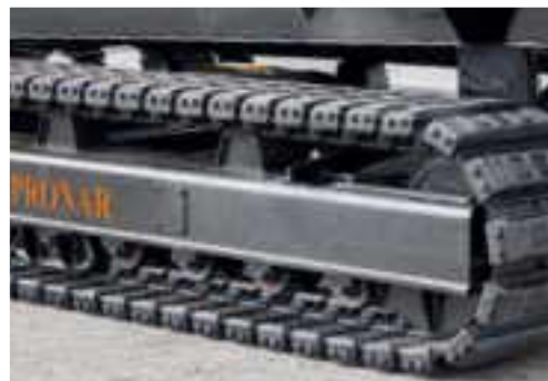
Gumowe nakładki na łożyska chronią podłogę przed porysowaniem stalowymi klepkami.
