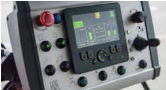
Panel sterowniczy -sterowanie wszystkimi funkcjami zmiatarki odbywa się za pomocą panelu umieszczonego w kabinie ciągnika
