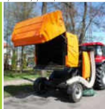
Hydrauliczny system opróżniania kosza
