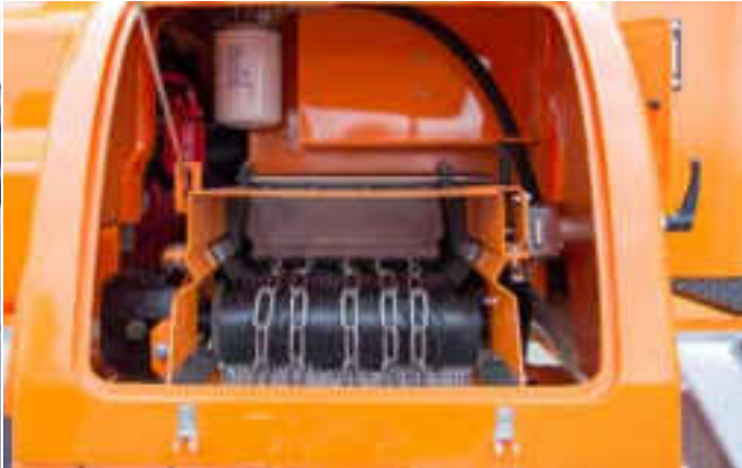
Materiał transportowany jest przenośnikiem taśmowym do układu zasypowego
