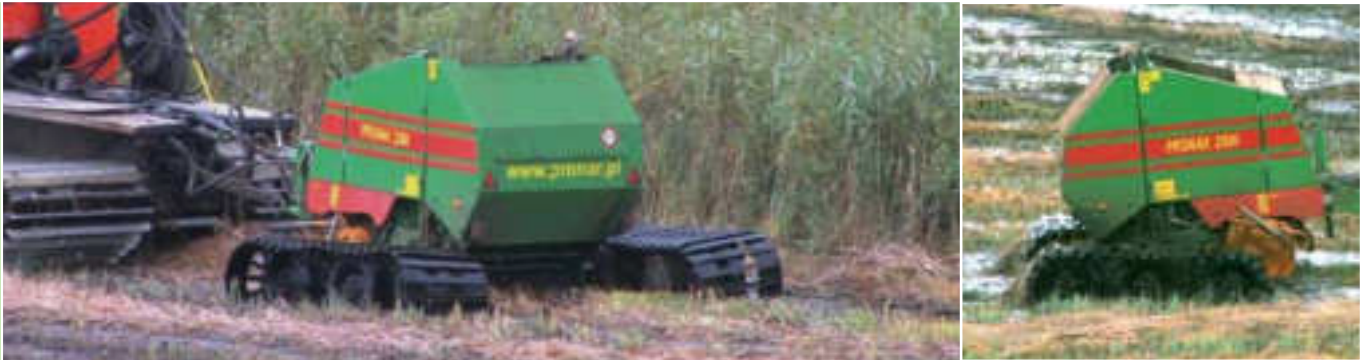
Prasa PRONAR Z500G - gąsienicowy układ jezdny pozwala pracować na podmokłych i bagiennych terenach
