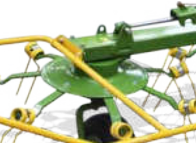
Mocna bezobsługowa przekładnia karuzeli
