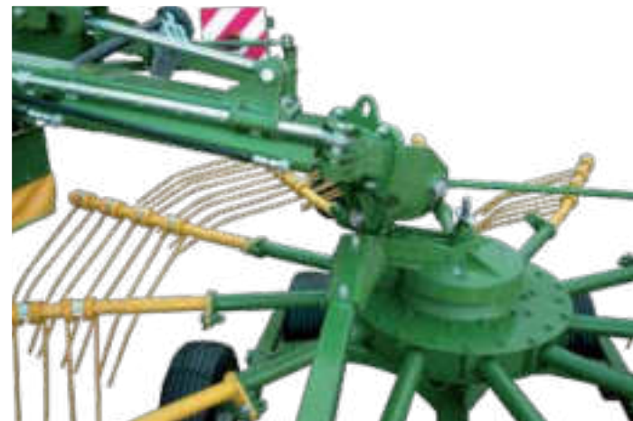
Siłowniki hydrauliczne regulujące szerokość roboczą maszyny – 7-8 m
