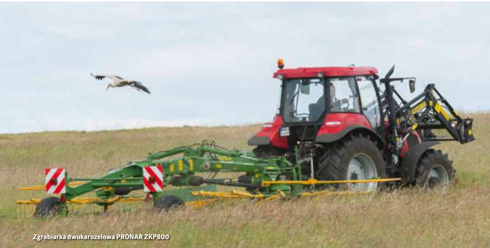
Siłowniki hydrauliczne regulujące szerokość roboczą maszyny – 7-8 m
