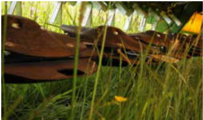
Palce urządzenia, wykonane ze stali odpornej na ścieranie, przechwytyują skoszony materiał z listwy tnącej
