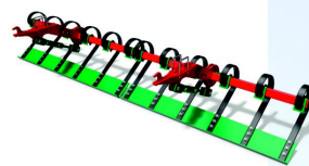
listwa zagarniająca regulowana hydraulicznie
