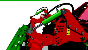
hydrauliczna regulacja wału
