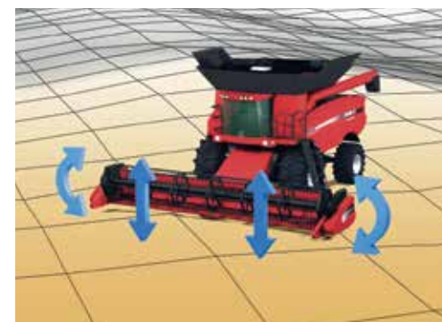
Stosowana przez markę Case IH technologia Terrain Tracker zapewnia utrzymywanie zadanej wysokości koszenia nawet na najbardziej nierównym terenie.
