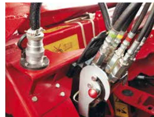
Montaż zespołu żniwnego w ciągu zaledwie kilku minut za pomocą jednego mechanizmu umożliwiającego podłączenie wszystkich złączy hydraulicznych
