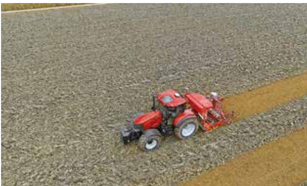
AFS AccuGuide: Układ prowadzenia oparty na technologiach GPS i GLONASS, zapewniający najwyższą precyzję, niezależnie od warunków płonu. Wykorzystanie systemu RTK gwarantuje poziom dokładności do 2,5 cm.
