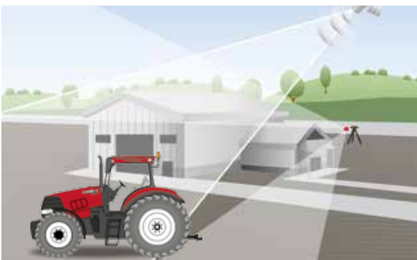
xFill pokrywa nawet 20-minutowe przerwy w odbiorze sygnału RTK.
