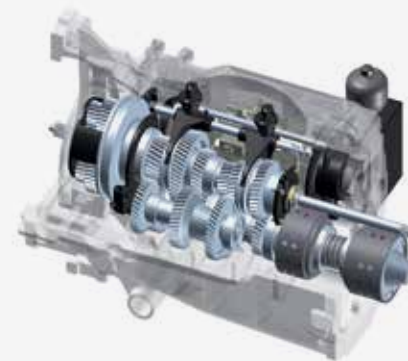
Przekładnia CVX – bezstopniowa jazda w zakresie prędkości 0-40 km/h
