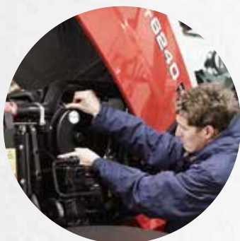
Ciągłe czyszczenie za pomocą filtru Piclon dba o to, aby filtr musiał być konserwowany tylko wtedy, gdy zaświeci odpowiednia lampka ostrzegawcza.
