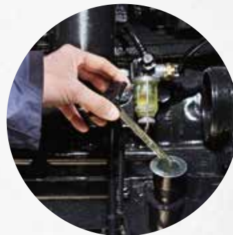
Kontrola poziomu oleju i uzupełnianie oleju bez podnoszenia maski silnika.
